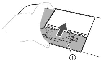
(1) Pokrywa płytki ściegowej
