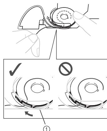
(1) Sprężyna regulująca naprężenie
